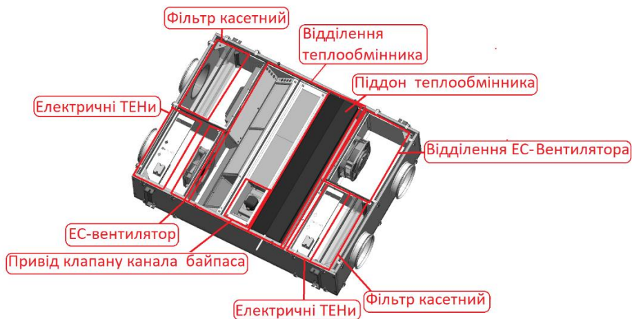
Рисунок 5 (б) Конструкція установки SlimStar
