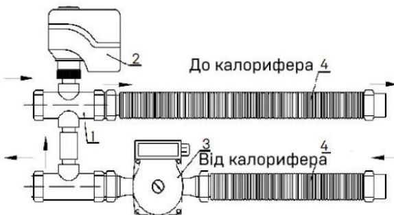
Рисунок 11 Типи та конструкція змішувальних вузлів
