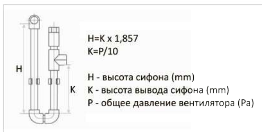
Отвод конденсата (рис. 10)
