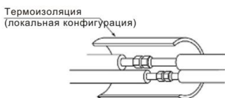
Иллюстрация 5.4. Изолирование трубопроводов.
