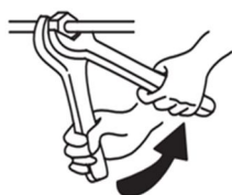
Иллюстрация 5.3. Затяжка накладных гаек.
