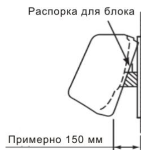
Иллюстрация 5.5. Применение распорки для блока.
