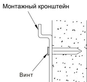
Иллюстрация 4.4. Инсталляция на кирпичной/бетонной стене.
