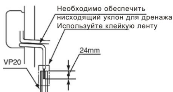
Иллюстрация 6.3. Подсоединение дренажного трубопровода.
