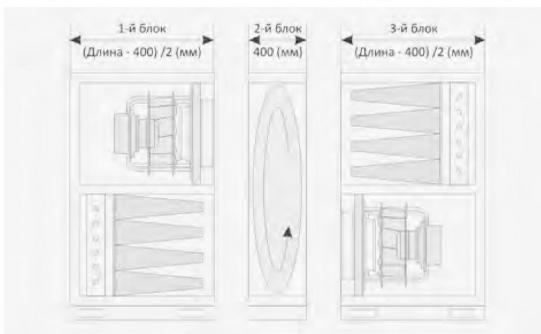
Рисунок 3 Секции установки
