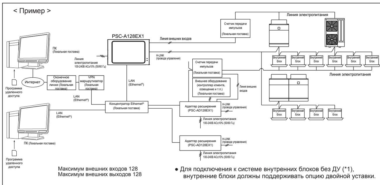
(\*1) Внутренний блок без RC, означает внутренний блок без дистанционного пульта управления. Это не включает случаи, когда несколько внутренних блоков подключены или настроены на мониторинг и управление с помощью одного пульта дистанционного управления.
