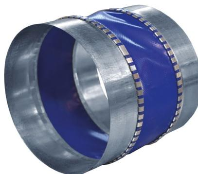
Гибкие вставки предназначены для исключения передачи вибрации от вентиляторов или вентиляционных установок к воздуховоду, а также для частичной компенсации температурной деформации в системе воздуховодов.
