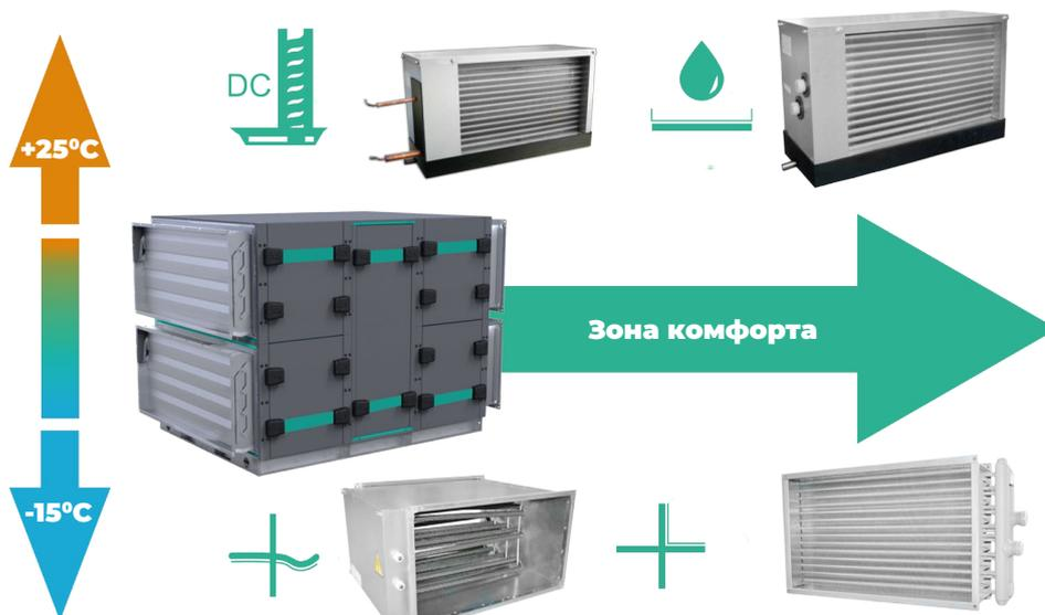
При низких температурах комфортные условия можно обеспечить встроенным водяным нагревателем или опционально канальным электрическим или водяным нагревателем.
