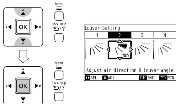
Угол перемещения заслонок будет изменен следующим образом.
